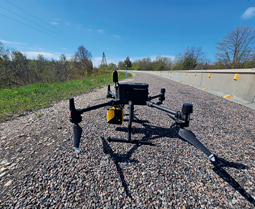
Bezpilota lidaparāts, aprīkots ar LiDAR sensoru (autors: M. Rutkovskis)
