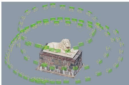
Fotogrāfiju izvietojums ap objektu 3D uzmērījuma iegūšanai (autors: M. Kaļinka)
