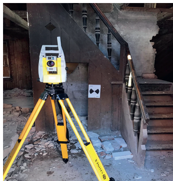
Marķieru izvietošana objektā lāzerskenēšanas vajadzībām (autors: J. Heinsbergs)
