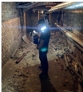
Darbs ar mobilo lāzerskenēšanas iekārtu tumšākās telpās (autors: J. Heinsbergs)
