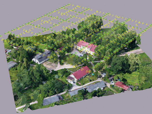
Fotogrāfiju novietojums virs objekta apvidus modeļa izgatavošanai (autors: M. Kaļinka)
