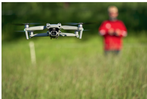
Bezpilota lidaparāts ar fotokameru (Adobe stock)
