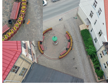
Marķieri pie objekta uzmērījumu veikšanai ar UAV (autors: J. Heinsbergs)
